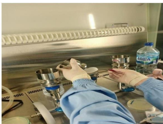
Gambar 4. Peletakan membran filter diatas tatakan tabung filtra
