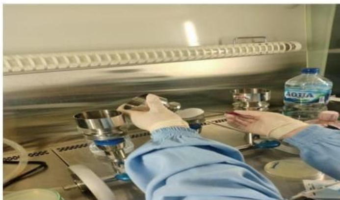
Gambar 2. Peletakan membran filter diatas tatakan tabung filtrasi
